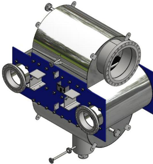
Der Apparat wird als Endkondensator verwendet und basiert auf unserem vollverschweißten Hybrid Tubular Plattenwärmetauscher. Der Dampf strömt auf der Primärseite von oben durch einen DN 700 Stutzen ein und kondensiert in den beiden in Reihe geschalteten Plattenpaketen auf der Rohrseite.
